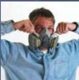
Ajuste la tensión de las correas hasta obtener un ajuste correcto. Tire de los extremos de las correas para ajustar la tensión. Comience por los puntos de regulación situados en la parte superior del respirador y, luego, pase a los puntos en la parte trasera del cuello. No las apriete demasiado. La tensión de las correas puede reducirse empujando hacia afuera por detrás de las hebillas.
